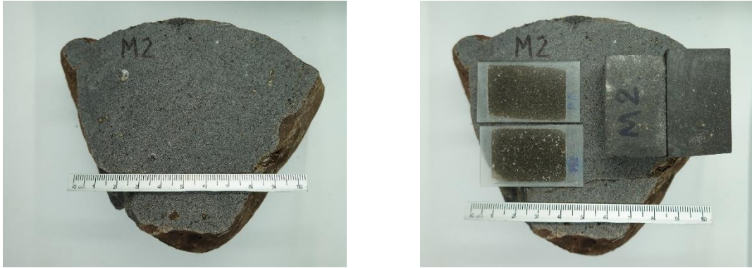
Figura 5. Muestra M2. a) Muestra de mano. b) muestra de mano, con los prismas y láminas delgadas preparados expresamente para el análisis microscópico.
