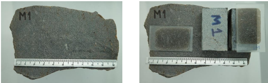
Figura 3. Muestra M1. a) Muestra de mano. b) muestra de mano, con los prismas y láminas delgadas preparados expresamente para el análisis microscópico.
